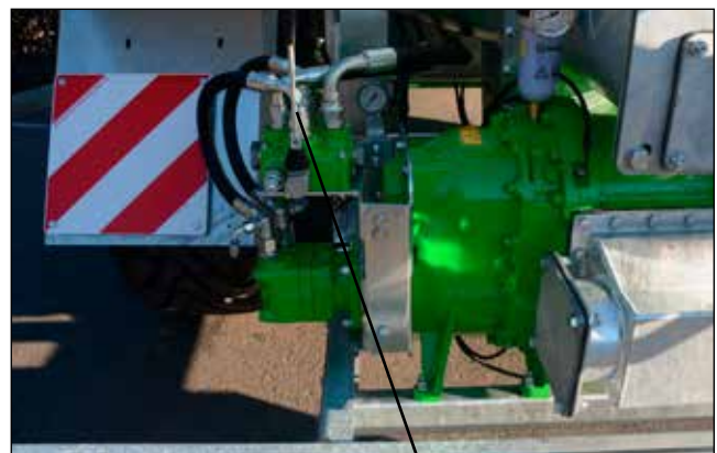
Bomba con lóbulos con un caudal de 6.000 l/min montada en la parte trasera
